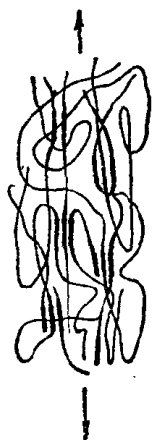
图5-8 纤维拉伸后的晶区和无定形区
